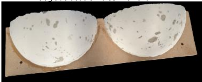
Double nid artificiel en béton de bois
