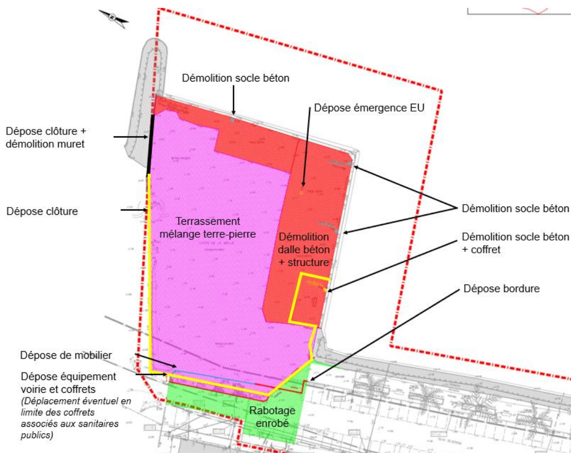
Figure 19 : Travaux de dépose/démolition
