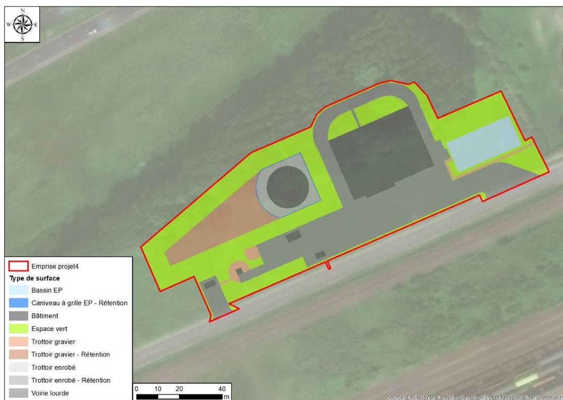
Figure 8 : Emprise du projet et répartition des types de sols
