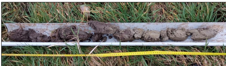
Photo 9 : Profil pédologique d'un THALASSASOL- REDOXISOL pachique à horizon réductique de profondeur (Sondage P10) - Photo prise sur site, © Rainette, 2023
