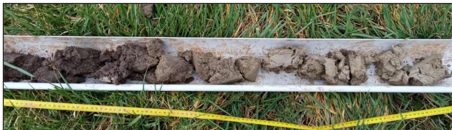
Photo 7 : Profil pédologique d'un THALASSASOL- REDOXISOL pachique, à horizon rédoxique de surface et réductique de profondeur (Sondage P6) – Photo prise sur site, © Rainette, 2023
