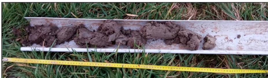
Photo 8 : Profil pédologique d'un THALASSASOL- REDOXISOL moyennement épais (Sondage P8) - Photo prise sur site, © Rainette, 2023
