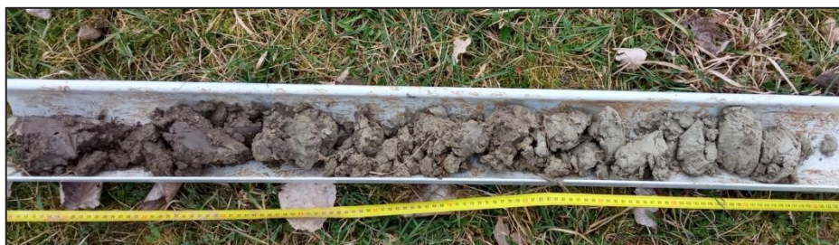
Photo 6 : Profil pédologique d'un THALASSASOL- REDOXISOL pachique, à horizon rédoxique de moyenne profondeur et réductique de profondeur (Sondage P5) – Photo prise sur site, © Rainette, 2023
