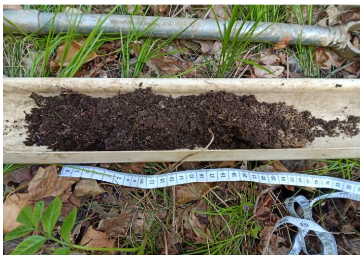
Absence de traces d'oxydoréduction d'un des sondages
