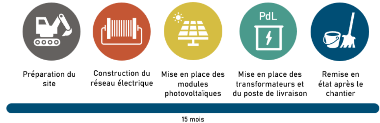
Figure 1 : Durées approximatives et phases de travaux de construction d'un parc photovoltaïque
