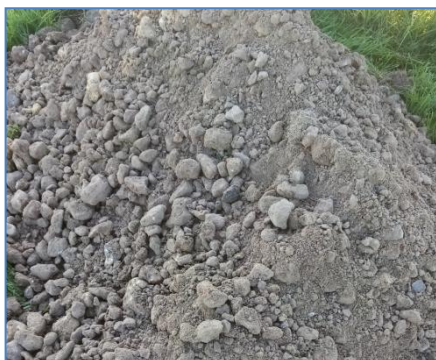
Graves à matrice limoneuse observées au droit du sondage P1
