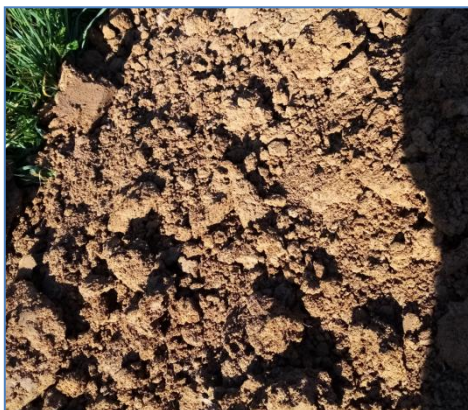
Limon marron brun +/- argileux observé au droit du sondage P2
