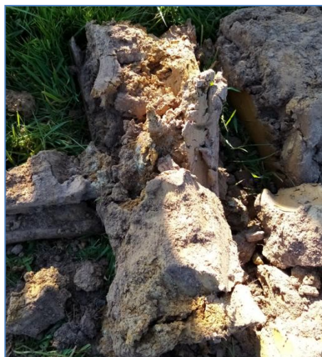
Argile marron beige bariolée observée au droit du sondage P4
