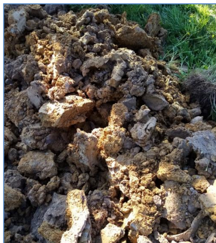
Argile marron beige bariolée observée au droit du sondage P4
