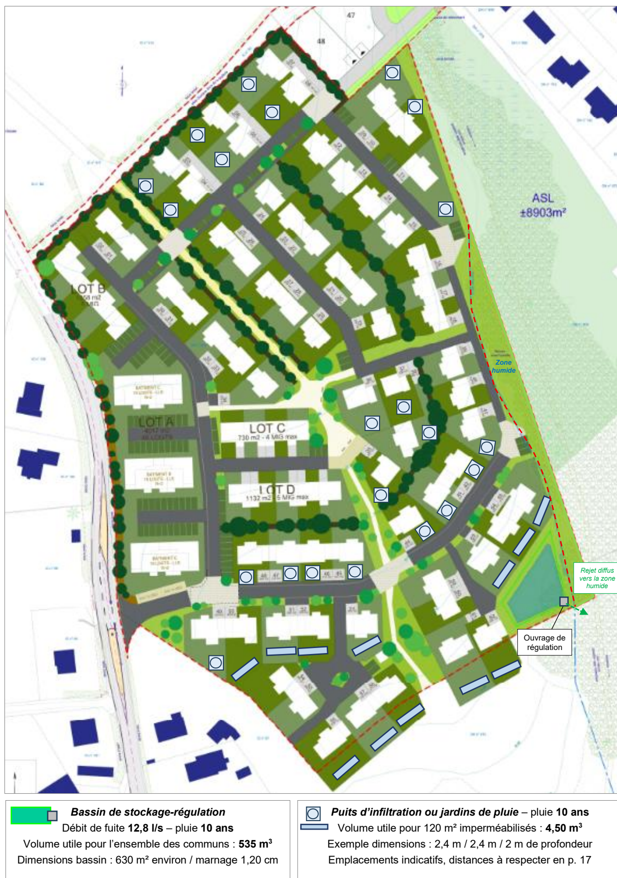
Figure 31 : Schéma de principe de l'aménagement pluvial (ABC, juin 2026)
