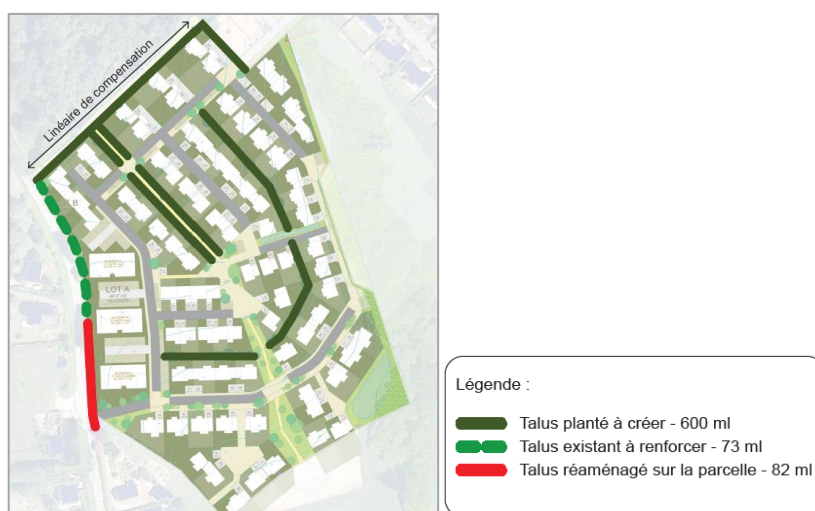
Figure 21 : Réaménagement du talus pour permettre un accès sécurisé
