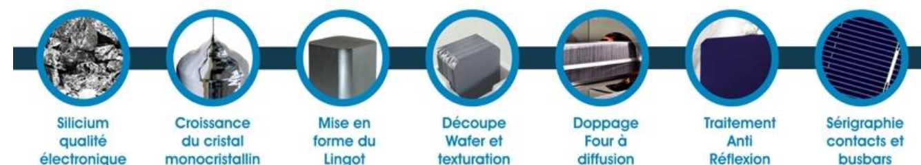
Figure 14 : Procédés de fabrication d'une cellule cristalline semi-conductrice de silicium (Source : Jade Technologie, s.d.)
