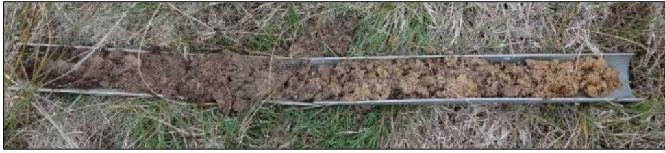
Figure 3 : Exemple d'une carotte de terre réalisée suite à un sondage.
