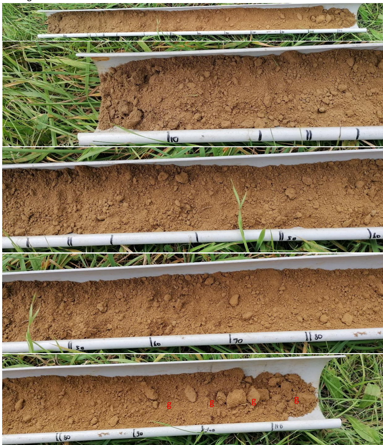
Traces rédoxiques de 95 cm jusqu'à 120 cm
