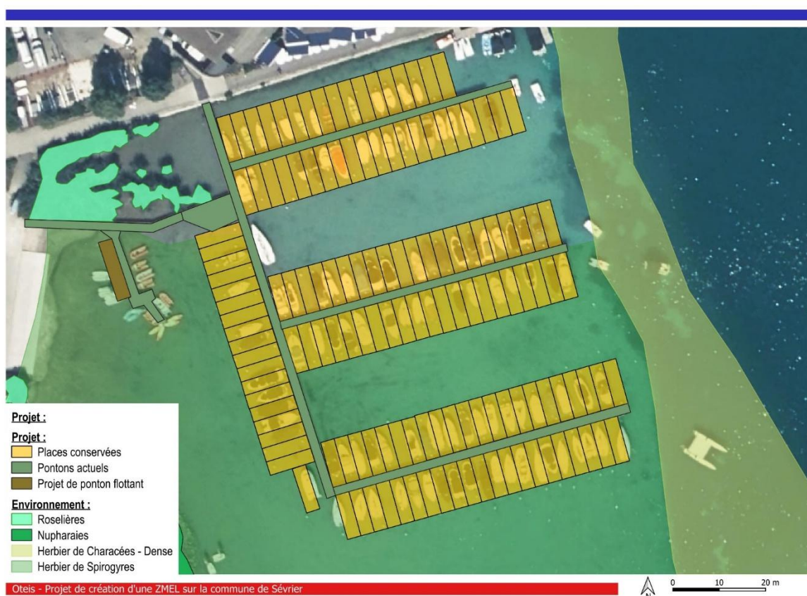
Figure 77 : Schéma de l'implantation du ponton flottant pour le kayak club
