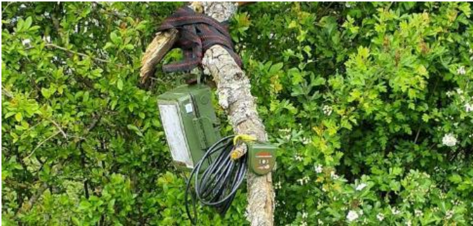
Photographie 7 – Un SM4BAT équipé d’un micro SMM-U2 installé sur une haie (source : Eco-Stratégie, 2024)
