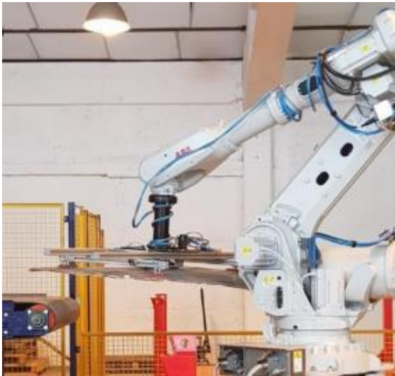
Figure 10 – Chargement du modules laminés avant découpage, broyage et séparation des éléments
