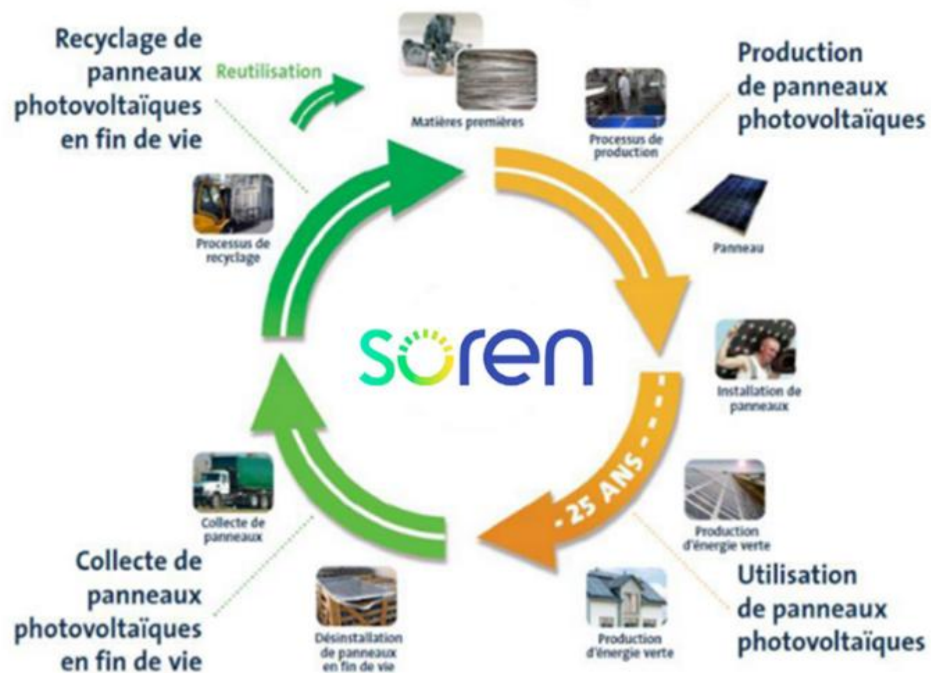
Figure 2 - Cycle de vie des panneaux photovoltaïques en silicium cristallin
