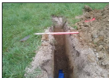
24/09/2025 : Test d'infiltration à niveaux variables de type MATSUO
