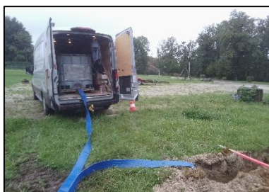
24/09/2025 : Test d'infiltration à niveaux variables de type MATSUO
