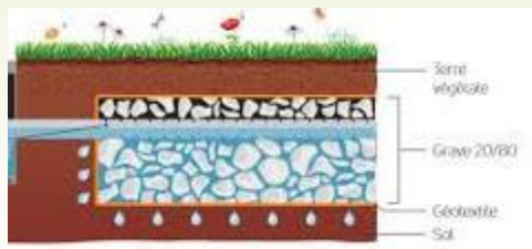
Tranchée de tamponnement
