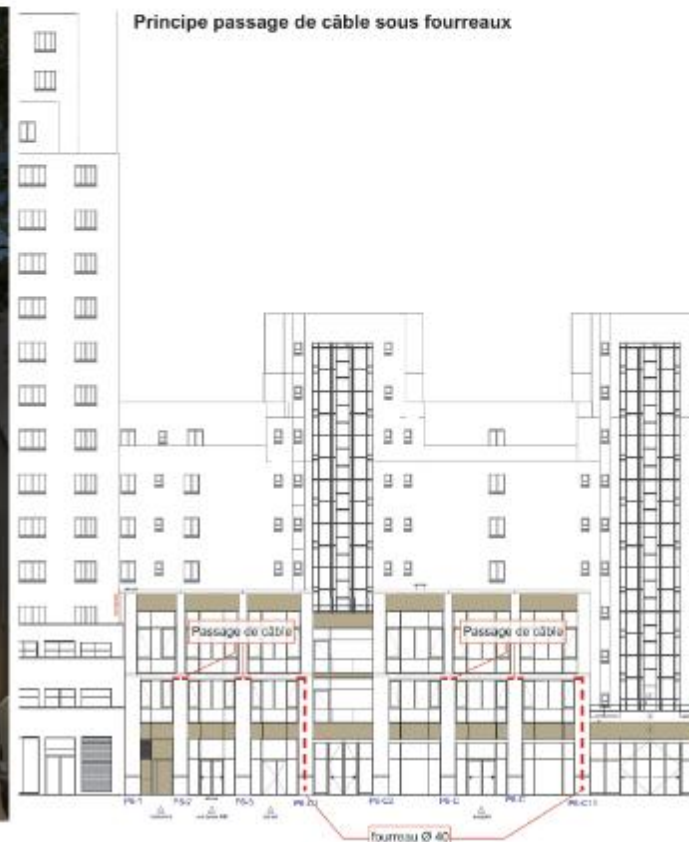
Principe passage de câble sous fourreaux
