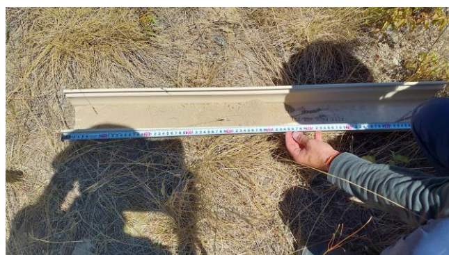
Figure 6 : Sondage complet positif zone humide avec traces d'oxydation
