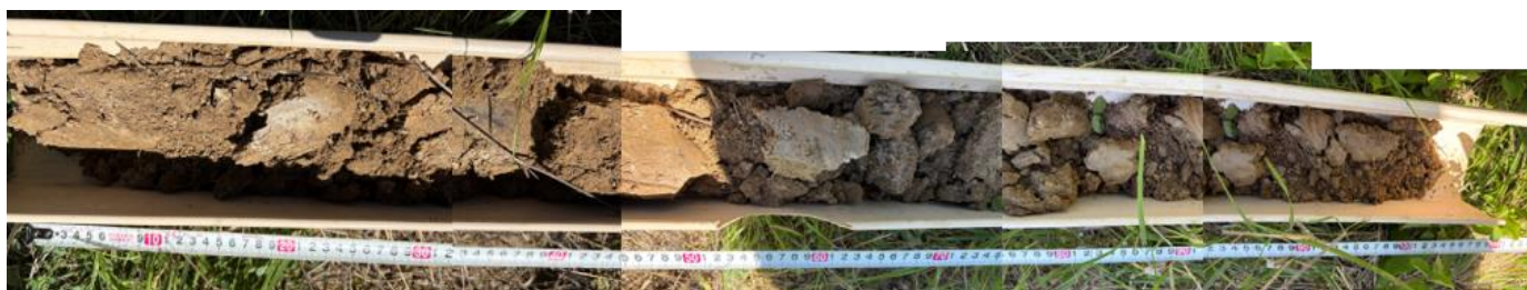
Figure 6 : Sondage complet positif zone humide avec traces d'oxydation
