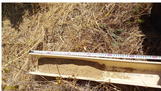
Figure 6 : Sondage complet positif zone humide avec traces d'oxydation
