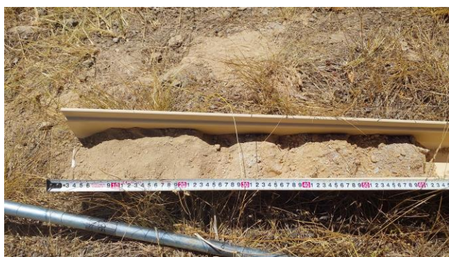
Figure 7 : Exemple de sondages avec refus de tarière.
