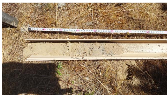
Figure 7 : Exemple de sondages avec refus de tarière.
