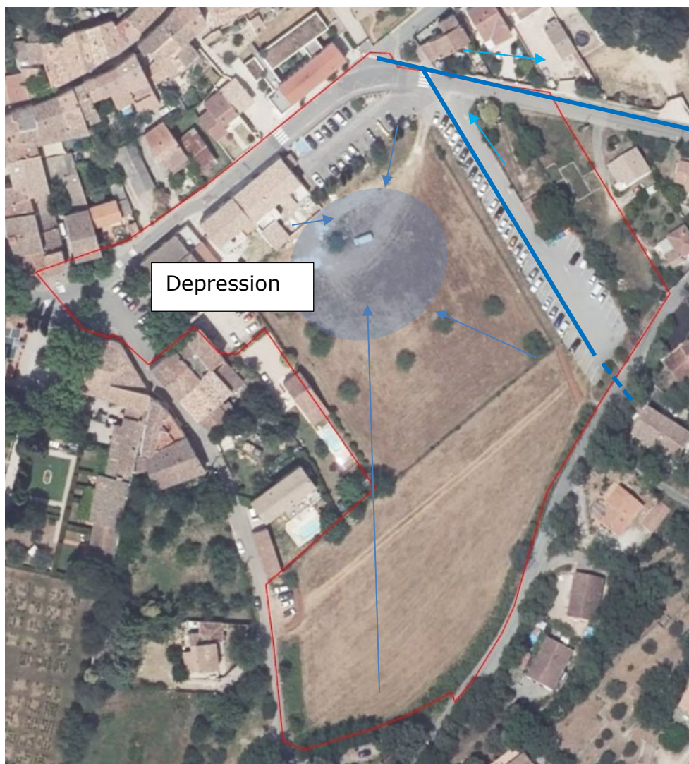
Figure 10: Principe du fonctionnement hydraulique actuel
