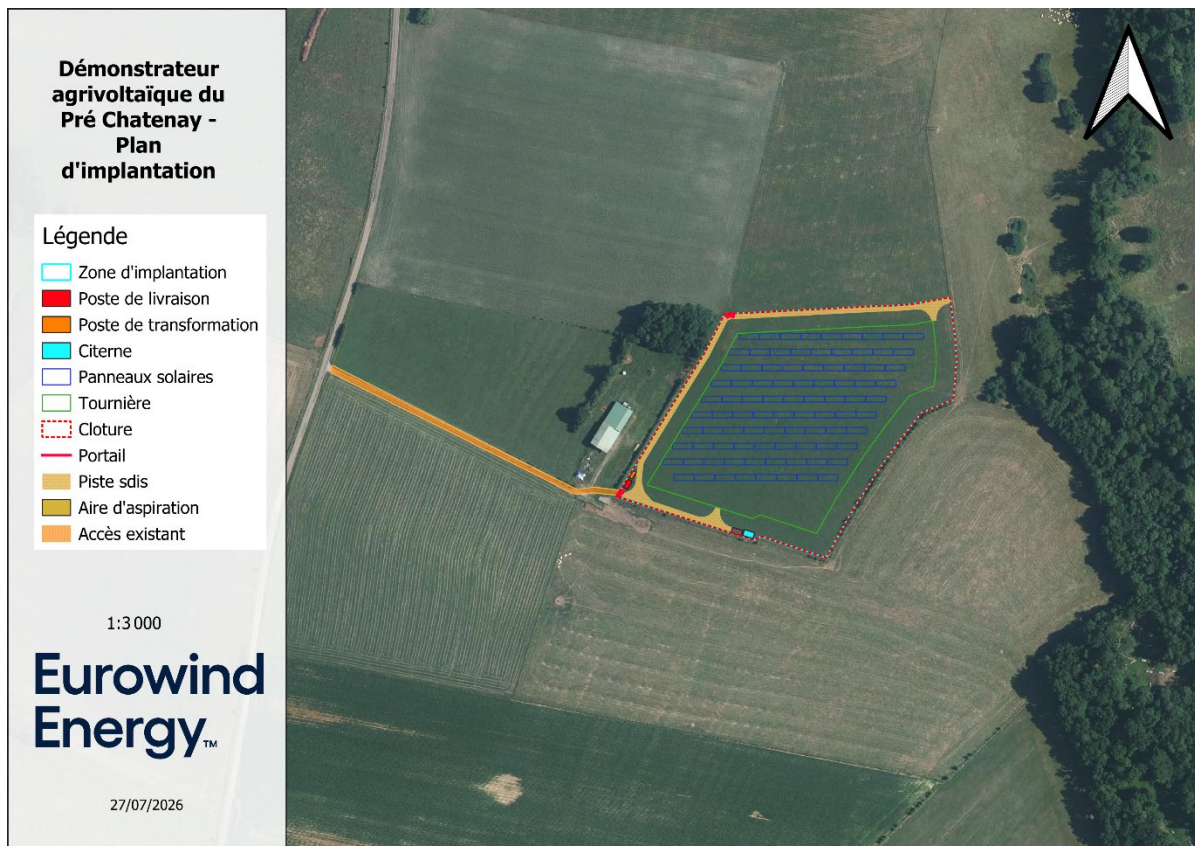
Figure 4 : Plan d'implantation du projet Agrivoltaïque du Pré Chatenay
