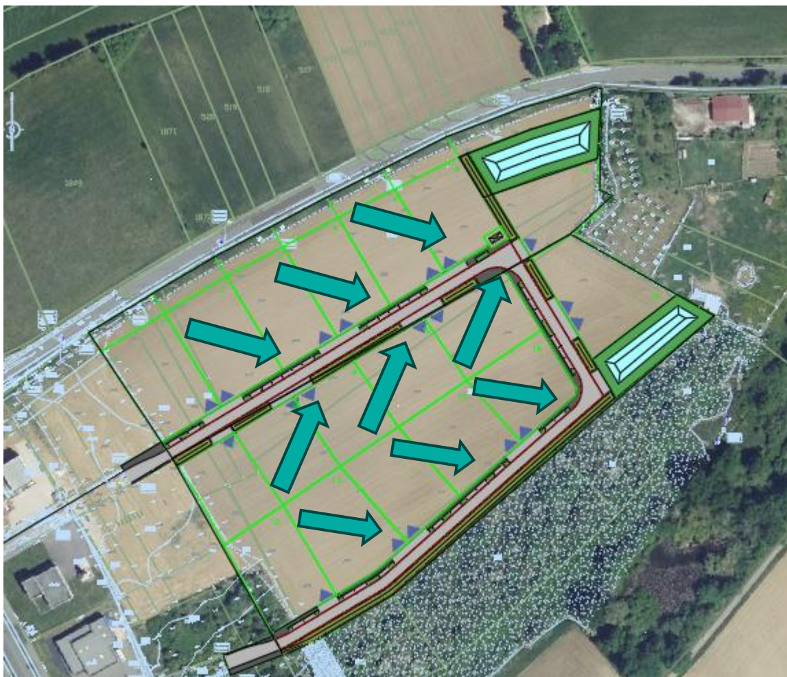
Sens de ruissèlement des eaux pluviales
