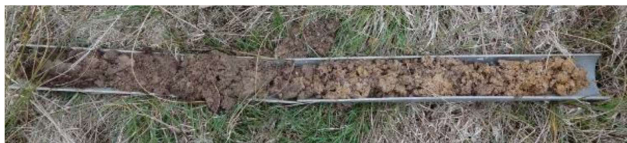
Figure 5 : Exemple d'une carotte de terre réalisée suite à un sondage
