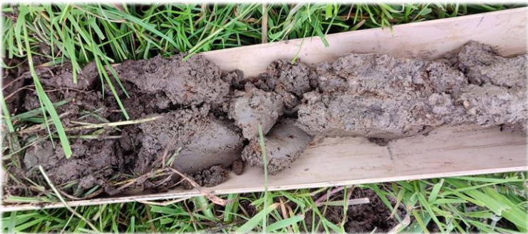
Zoom sur les 25 premiers cm du sondage S2 (Hydromorphe – traces d’oxydoréduction)
