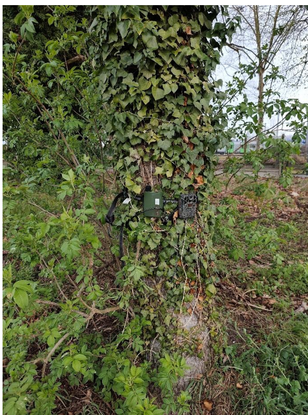
Enregistreur Song Meter Mini Bat de Wildlife acoustics utilisé dans le cadre des investigations
