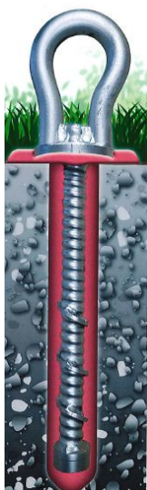
Figure 26 : Schéma d'une ancre à scellement
