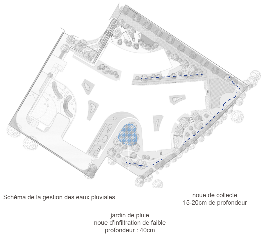
exemple : donner à voir un espace en creux et planté pour capter le pluvial, qui accompagne la forme architectural
