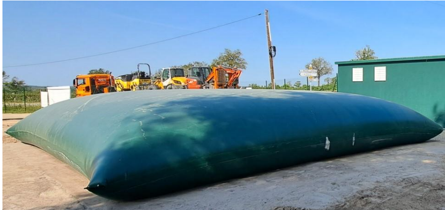
FIGURE 5. EXEMPLE DE CITERNE INCENDIE
