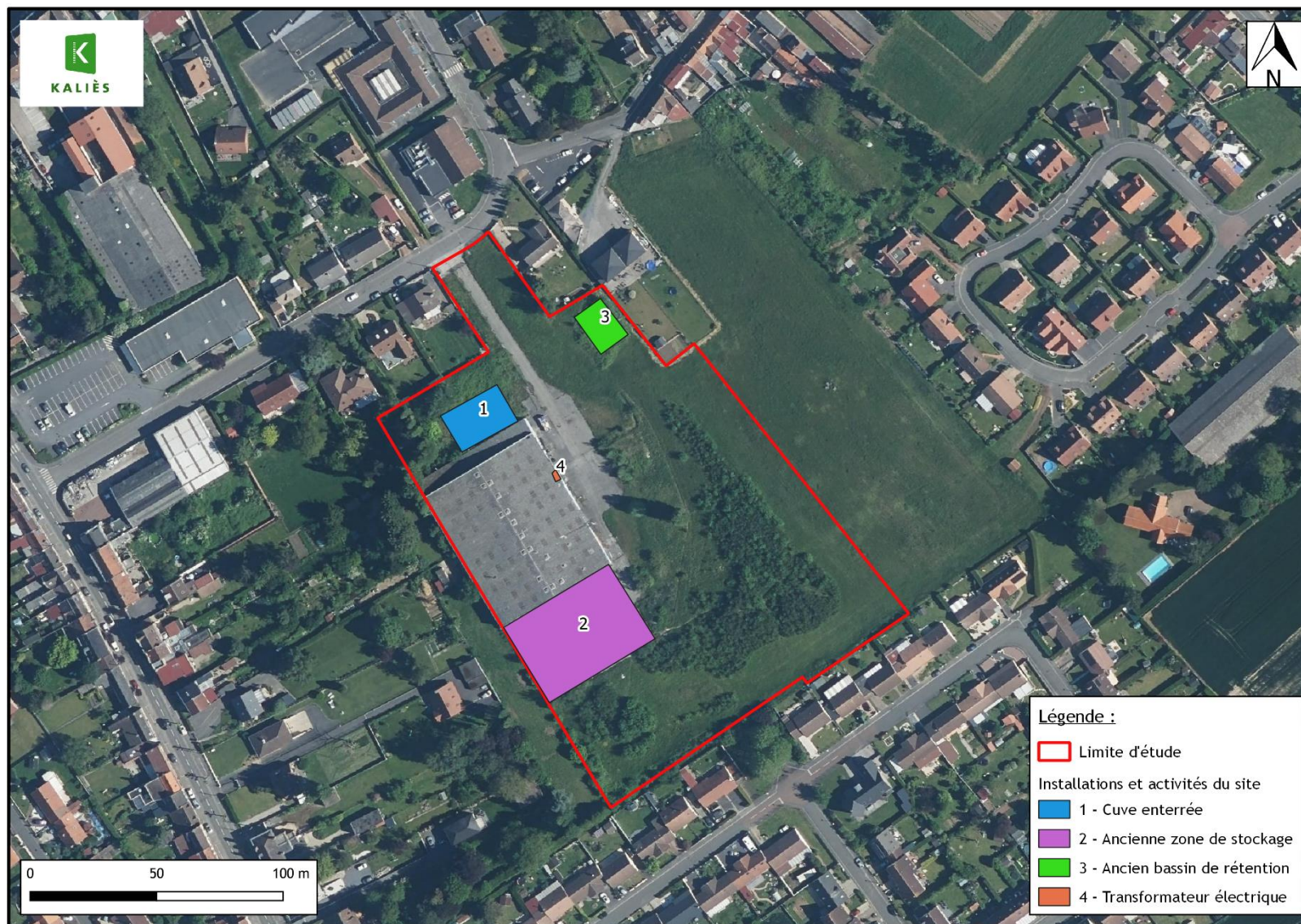
Figure 5 : Installations du site
