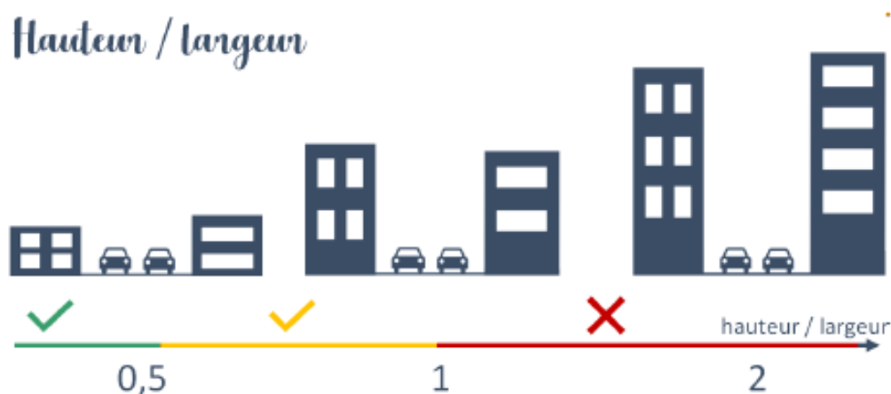
Figure 22. Variation du rapport hauteur du bâti/largeur d'une rue-canyon et impact sur la qualité de l'air (Source : Air Pays de la Loire, 2021)
