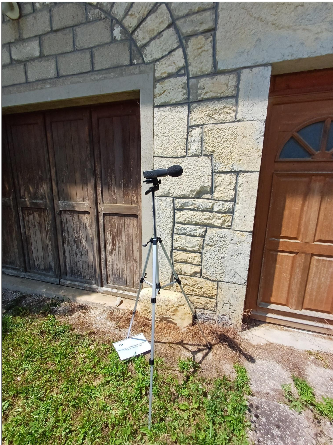
Figure 14 : Photographie du sonomètre lors des mesures des niveaux sonores en limite de Zone à Emergence Règlementée (Point ZER-2 sur Figure 1)
