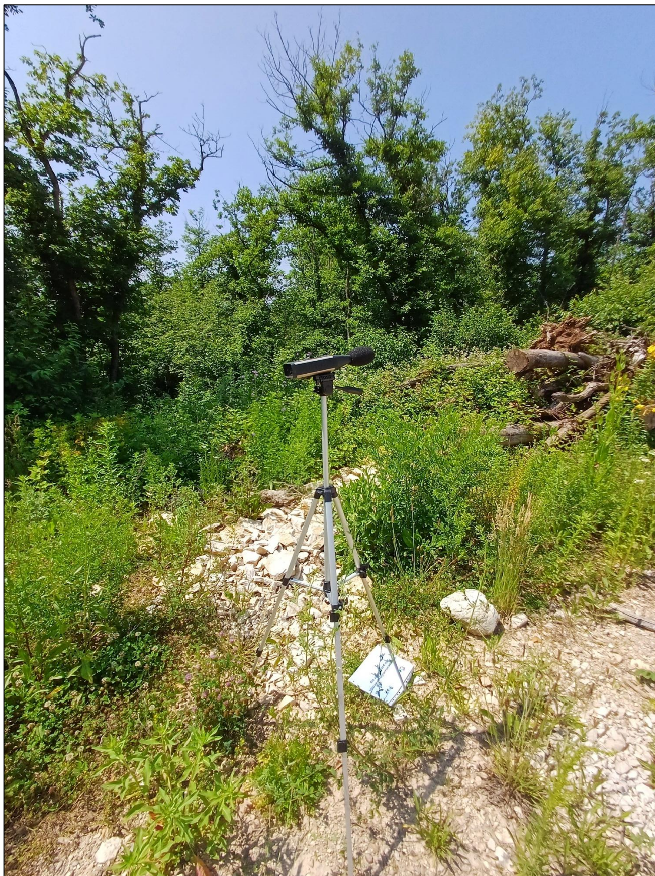
Figure 11 : Photographie du sonomètre lors de la mesure du niveau sonore en limite de site (point LIM sur la Figure 1)
