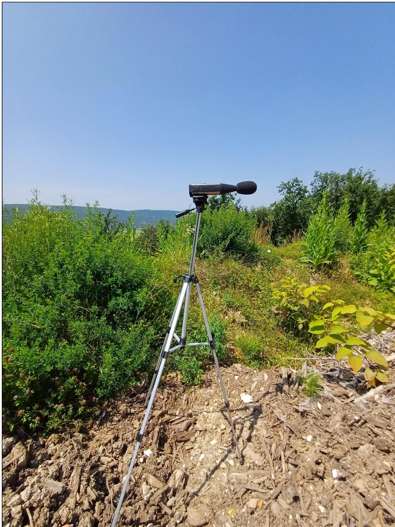
Figure 12 : Photographie du sonomètre lors de la mesure du niveau sonore en limite de site (point LIM-ISDI sur la Figure 1)
