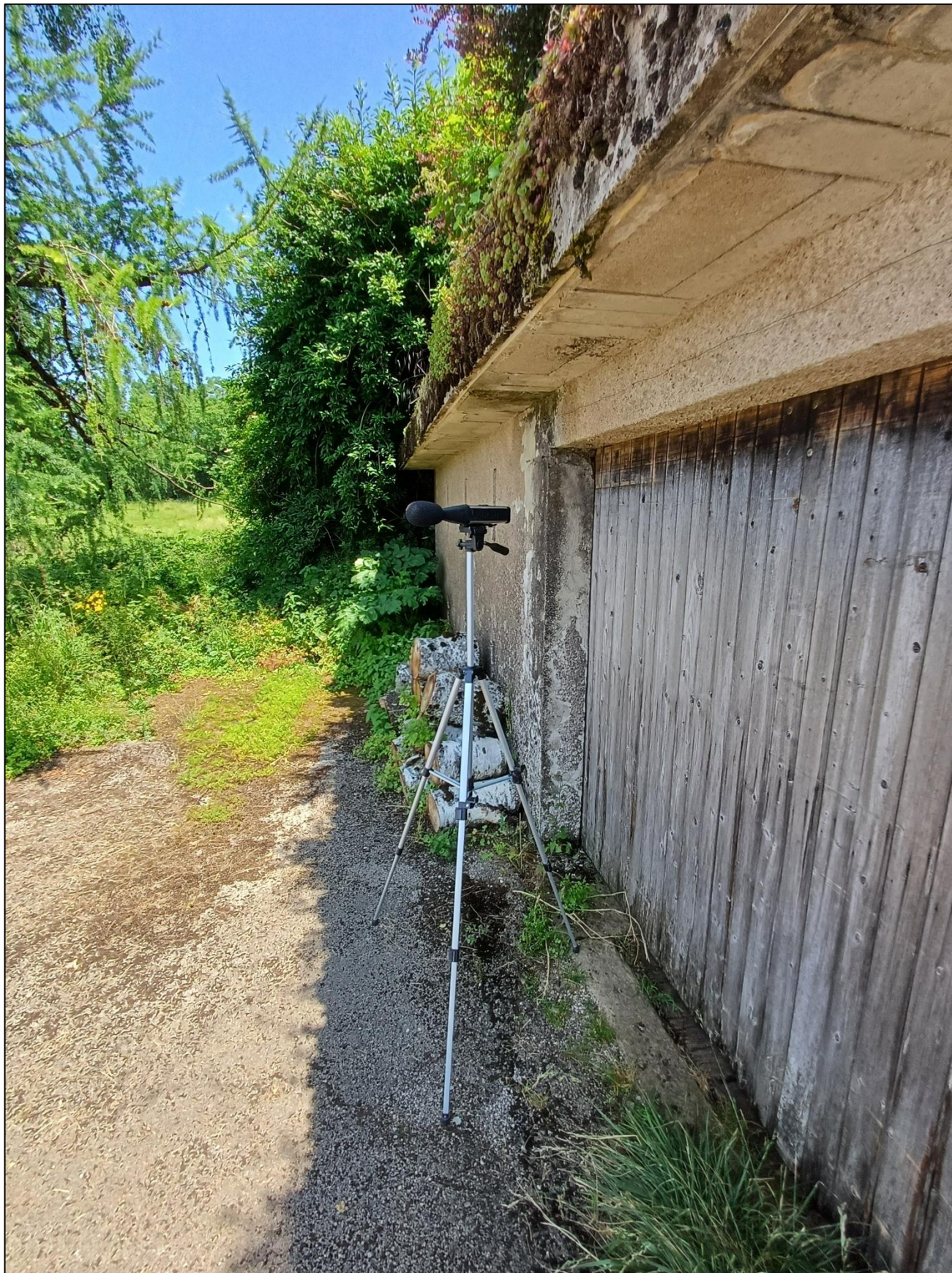
Figure 13 : Photographie du sonomètre lors des mesures des niveaux sonores en limite de Zone à Emergence Réglementée (Point ZER-1 sur Figure 1)
