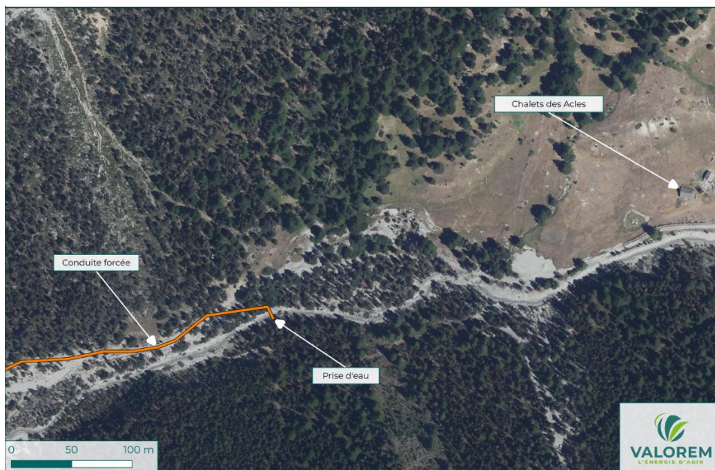
Figure 7 : Vue aérienne de la zone d'implantation de la prise d'eau
