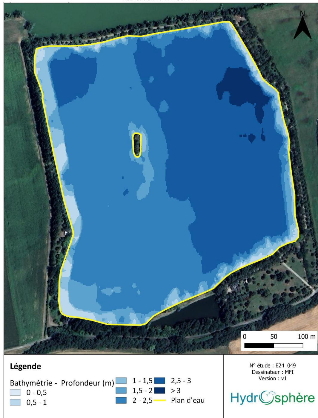
Illustration 5 : Bathymétrie au droit du plan d'eau du site d'étude (Lac de Pel Rouge) Réalisation : HYDROSPHERE
