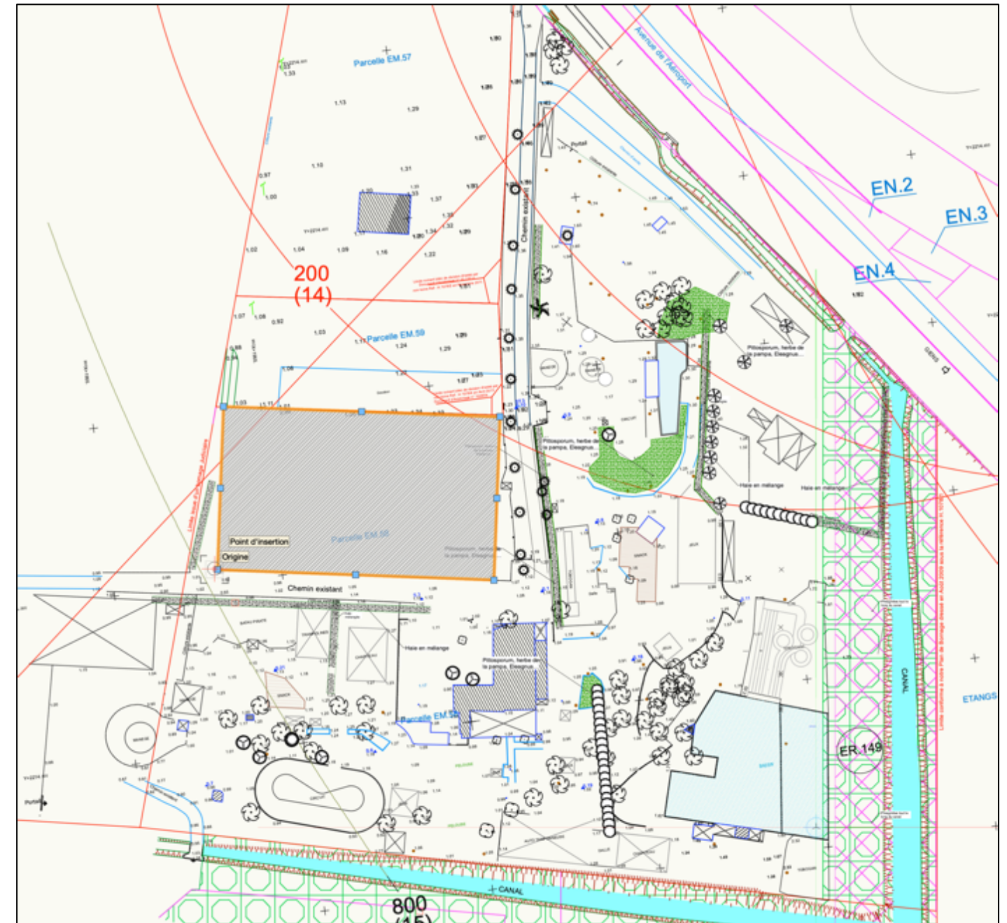
Figure 10 : Schéma de la surface minimale nécessaire au parking à créer.
