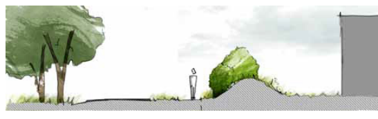
Illustration d'une limite traitée avec un talus planté
