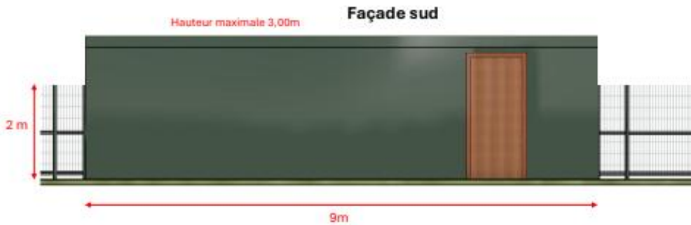
Figure 59 : Exemple d’un poste de livraison préfabriqué, faisant l’objet d’une insertion paysagère
