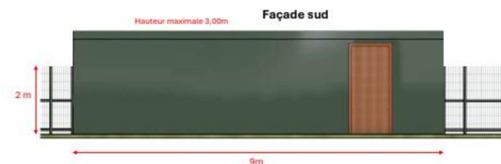
Figure 55 : Poste de livraison préfabriqué
