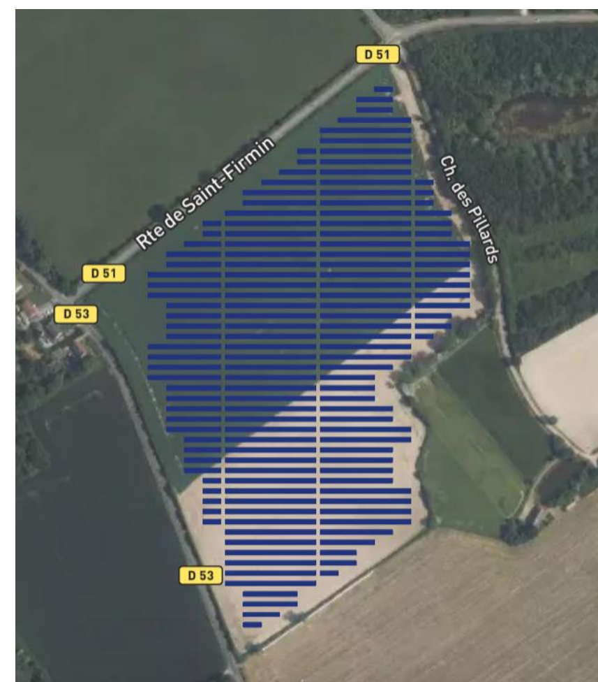
Figure 46 : Variante 1, utilisation d'ombrières fixes orientées plein sud
