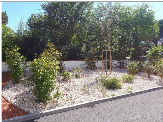
F.11 - Coefficient de ruissellement faible pour les espaces verts xérophiles et les places de parking perméable.
