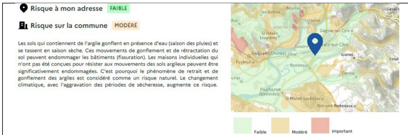
Fig. 5 - Prise en compte du risque argile "modéré" dans la conception du projet.
