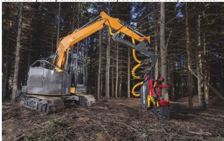
Fig. 13. Exemple de scie multifonction sur pelle
