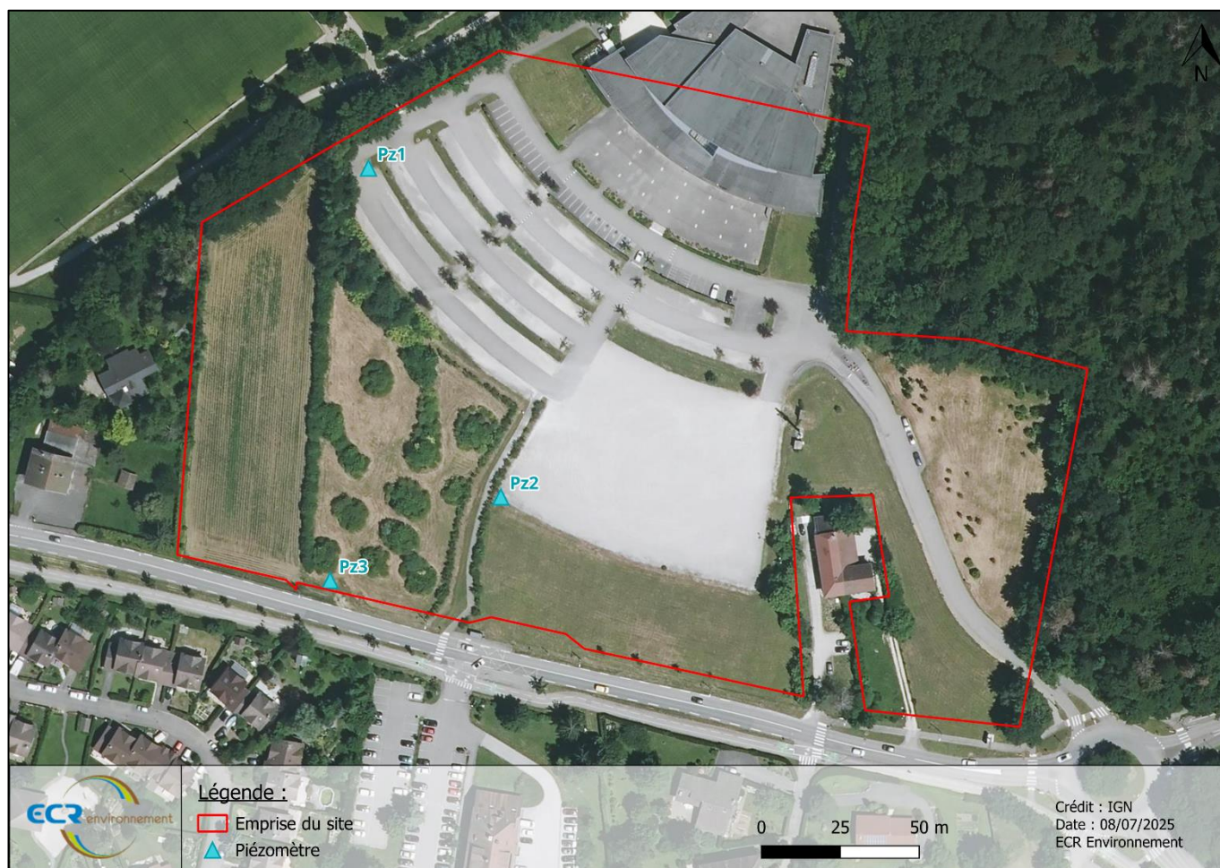
Figure 19 : Localisation des ouvrages piézométriques installés au droit du site
