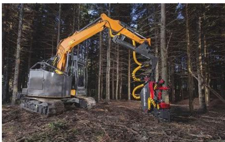
Figure 52 : Exemple de scie multifonction sur pelle (Alp'Pages Environnement, 2026)
