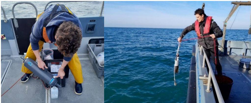
Figure 4 : (A gauche) collecte d'un échantillon d'eau avec la bouteille Niskin ; (à droite) mise en œuvre de la sonde multiparamètres (NKE WIMO)
