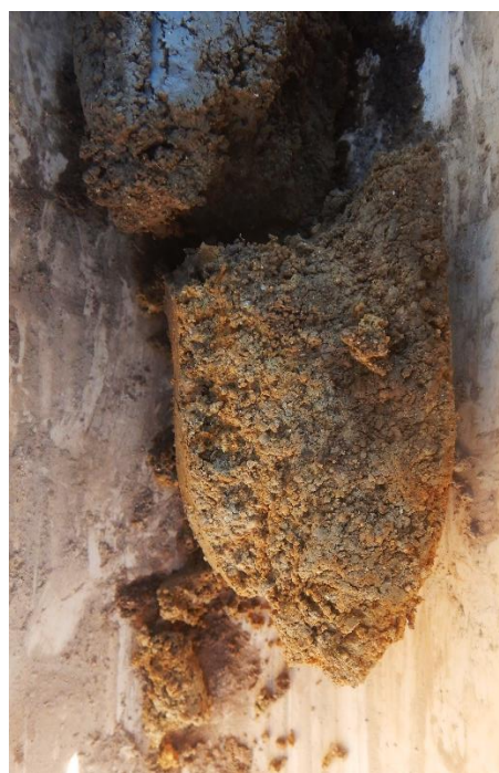
Hydromorphie marquée par des taches de rouilles et une forte décoloration grise à partir de 45 cm
