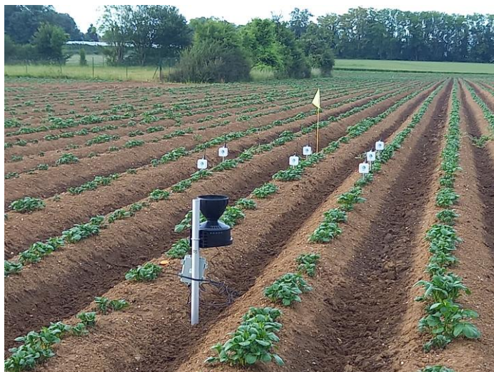
FIGURE 7 : STATION TENSIONNETRIQUE DANS UN CHAMP DE POMME DE TERRE
