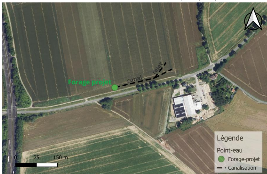
FIGURE 20 : CARTE MONTRANT LE LIEU DE REJET DES EAUX DE POMPAGES
