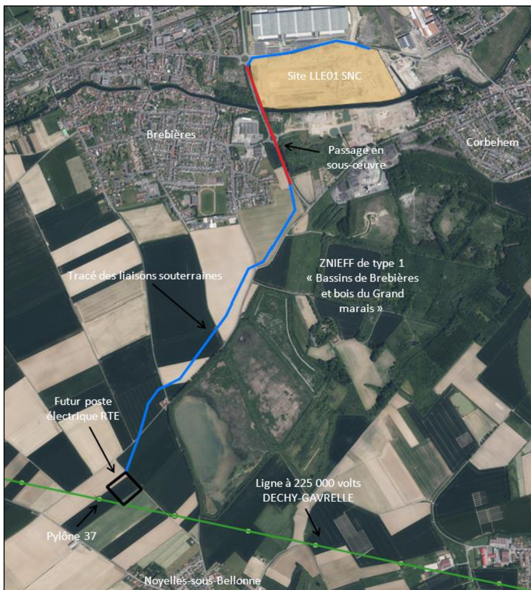
Illustration 7 : Localisation du poste et tracé de principes des futures liaisons souterraines
