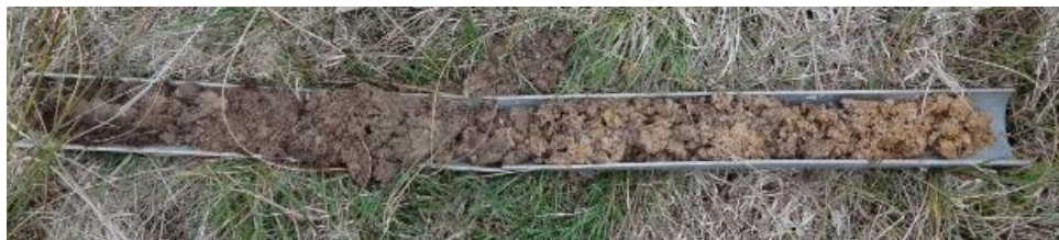
Figure 10 : Exemple d'une carotte de terre réalisée pour donner suite à un sondage
