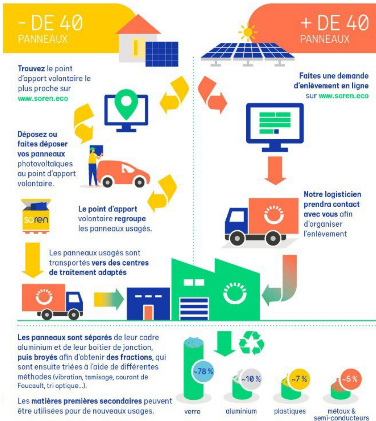
FIGURE 7 : SCHEMA DE PRINCIPE DU RECYCLAGE DES PANNEAUX SOLAIRES (SOURCE : SOREN)
