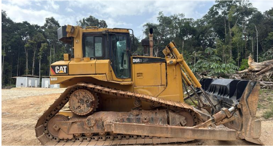
Figure 2 : Bulldozer D6R LGP III de 19 tonnes utilisé pour le décapage du mort-terrain et la réhabilitation.
