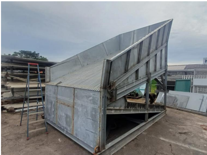
Figure 3 : Laverie mobile utilisée pour la récupération gravimétrique de l'or.
