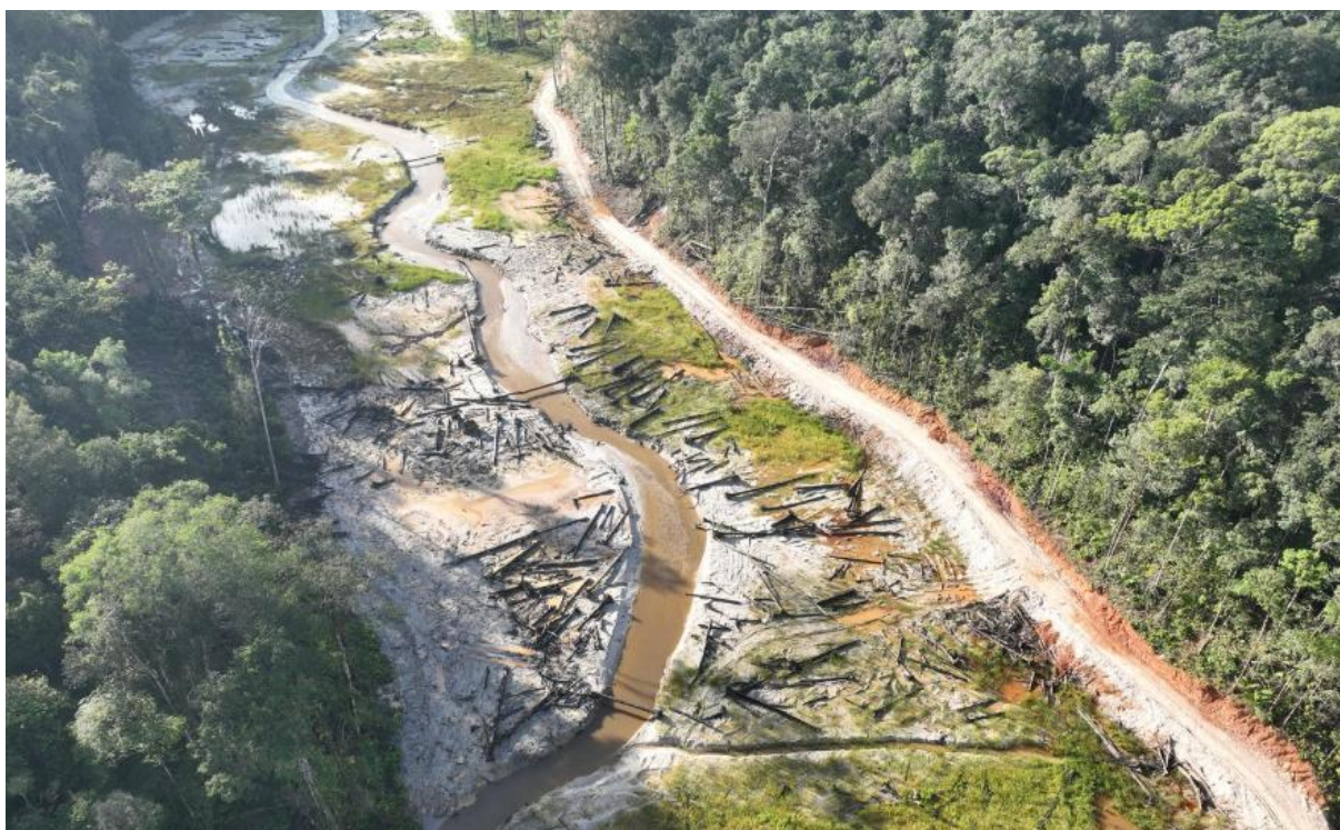
Figure 42 : Reprofilage de la crique et début de réhabilitation de l'AEX « Bon Espoir » 06/2023 au début mois de mai 2025.
