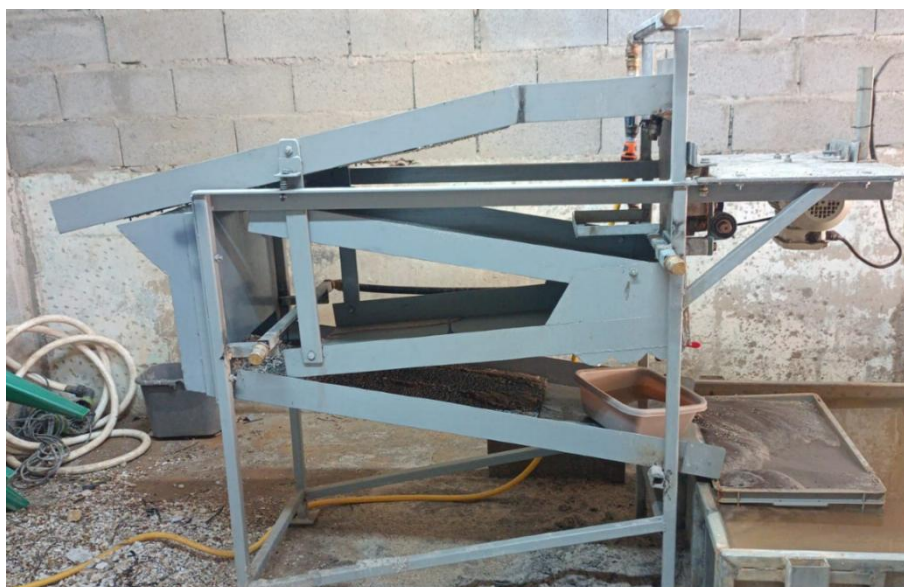
Figure 5 : Crible vibrant de laboratoire utilisé pour le nettoyage du concentré aurifère par gravimétrie.
