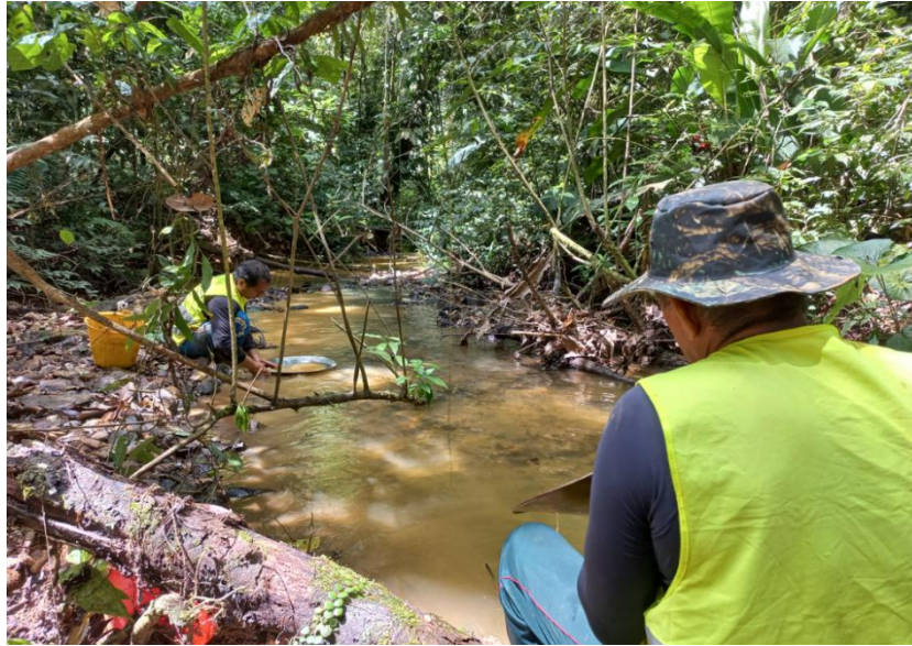
Figure 31 : Concentration des échantillons de gravier à la batée (D. Seira, le 28/10/2021).
