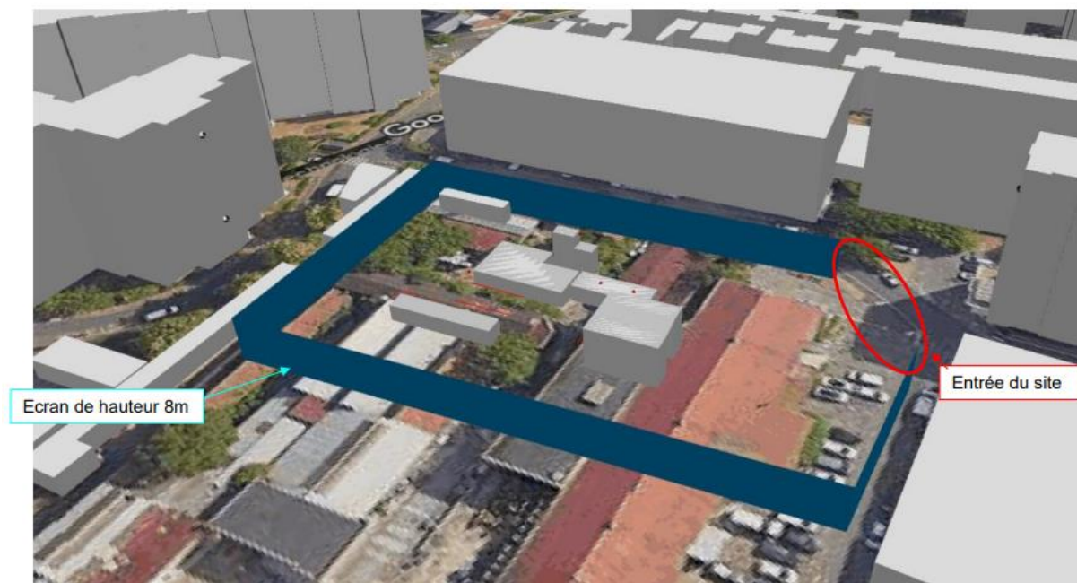
Figure 24 – Mise en place d'un écran acoustique pour limiter l'impact du bruit sur les commodités autour du projet (Source : AD Ingénierie)
