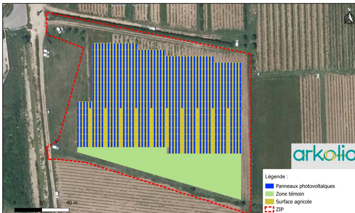
Figure 9 : Emplacement des modules pour suiveurs de soleil (automne hiver) et agronomique (printemps été), surface agricole associée et zone témoin
