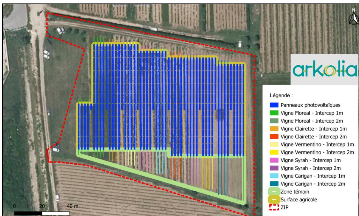
Figure 10 : Emplacement des modules pour suiveurs de soleil (automne hiver) et agronomique (printemps été), surface agricole associée et zone témoin (version 2)
