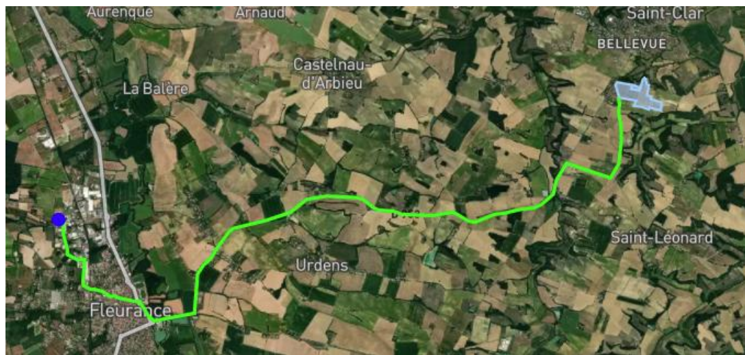
Tracé du raccordement envisagé jusqu'au poste source
