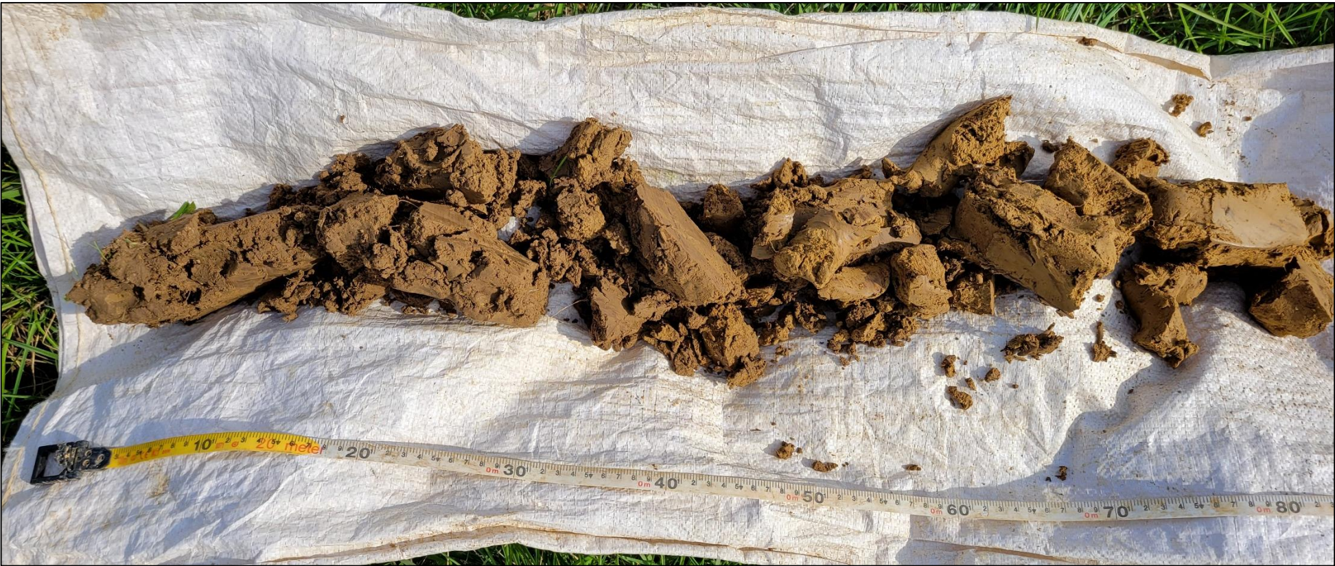
Photo 7 : Détail du sondage n°5 (Source : BEJC)
