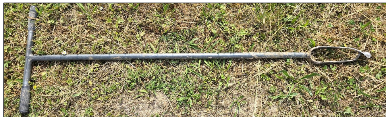
Photo 2 : Tarière Edelman ayant servie à réaliser les sondages pédologiques (Source : BEJC)
